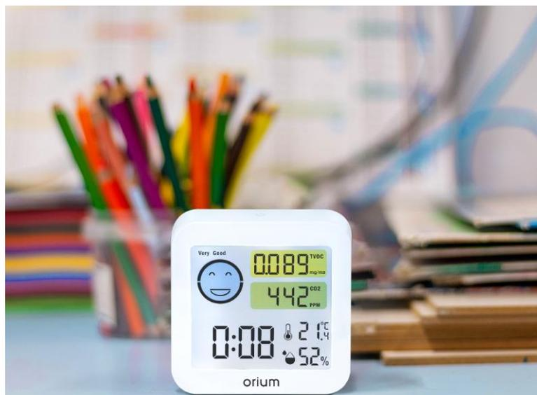
Lors de l'utilisation sur piles : les mesures de COV et de CO2 ne sont pas effectuées automatiquement afin d'économiser les piles. Effectuer les mesures manuellement comme indiqué. Les nouvelles mesures de COV et de CO2 sont affichées à la fin du décompte de 5 minutes. Puis le mesureur Quaelis est à nouveau en mode veille (pas de mesures de COV et de CO2).
